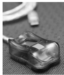
Lecteur biométrique: il reconnaît les empreintes de l'utilisateur et accorde l'accès
